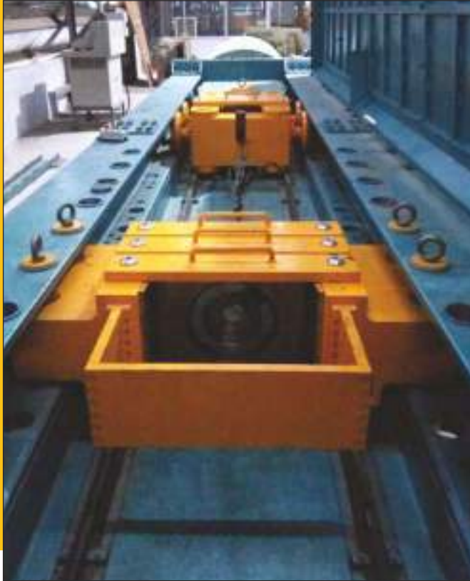
500 Ton Testing Bed
